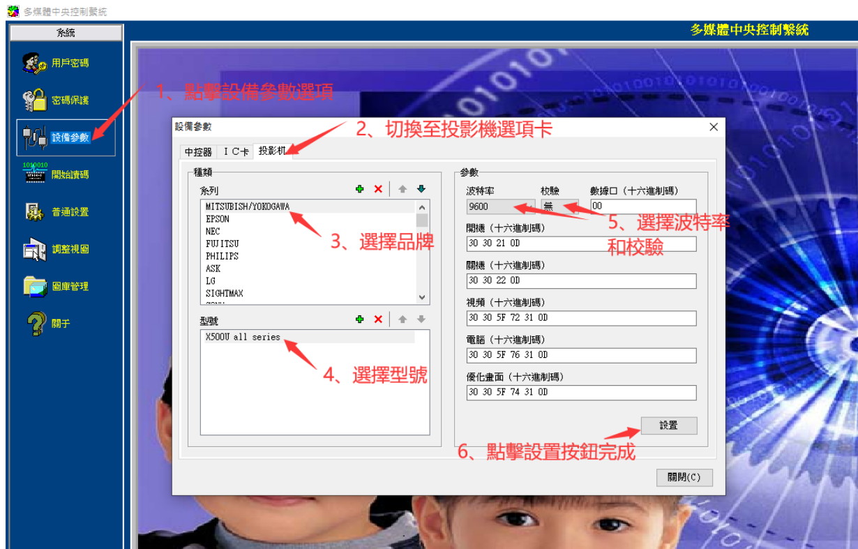
上圖是使用RS-232串口方式控制顯示設備時的指令寫入方法和步驟
